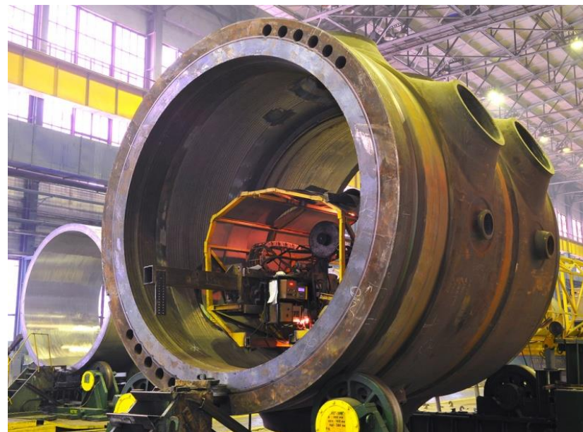
VVER-1200 csonkgyűrű gyártása
