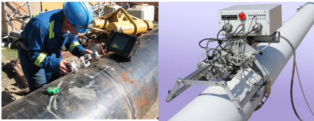
5.27. ábra. Bal oldalon: Félautomata letapogatás Omniscan-nel, főleg a kézi mozgatósi hibák kiküszöbölésére; jobb oldalon: ez az automata ultrahangos letapogató rendszer végigmegy az épülő olajvezetéseken [ NDT web ]
