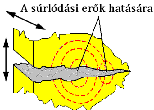
5.29. ábra. A súrlódás az anyagon belül is akusztikus eseményt kelt [NDT web]
