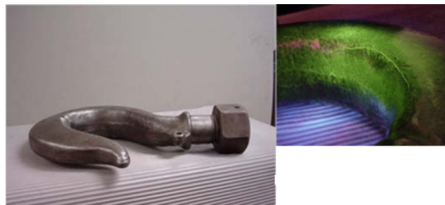
5.12. ábra. Daru horgának repedése [NDT web]
