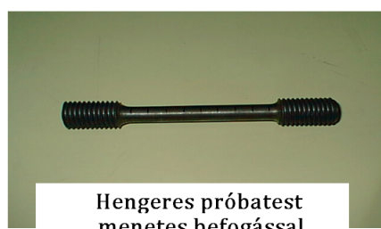
4.3. ábra. A hengeres (a) és a lemezes (b) szakító próbatestek méretei: d - az átmérő (mm), a és b - a téglalap keresztmetszet oldalhosszai (mm), s - a keresztmetszet ( mm^2 ), L - a hossz (mm), alsó index: 0 - a terheletlen méret [Csizmazia2], [Jarfas]
