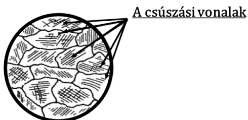
2.13. ábra. A csúszási vonalak mikroszkópos képe a krisztallitokban [Csizmazia1], [Prohaszka], [Jarfas]
