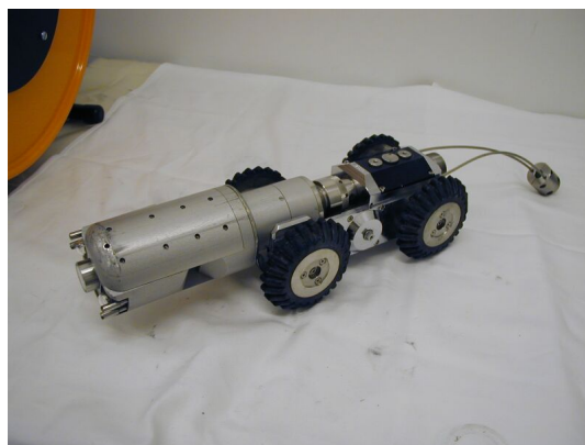
6.9. ábra. Távézérelt önjáró kamera. Beépített világítás, forog, billen, zoomol [Bacsikai P. foto]
