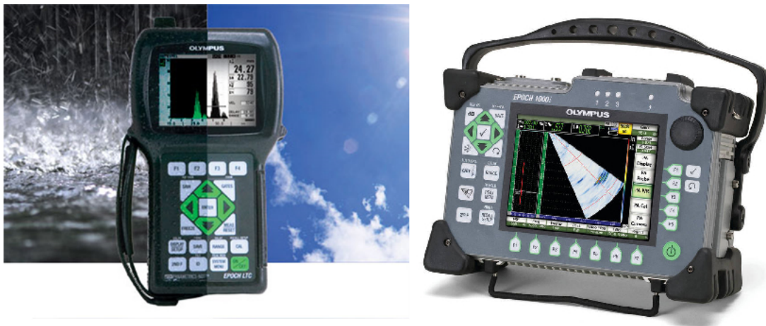
5.26. ábra. Bal oldalon: Olympus Epoch LTC könnyű, kézi mérőeszköz; jobb oldalon: Olympus Epoch 1000 típusú, drága, de fázisvezérelt, beépített intelligenciákkal, és a fejek kalibrációs görbéivel rendelkező mérőeszköz [ Olympus web ]
