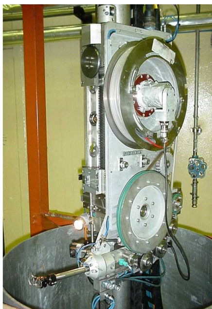
6.31. ábra. Kraftwerk Union gyártmányú feltét (support). Baloldalt látható a vízszintes helyzetű szondabevezető és referencia cső. A support árboca lehetővé teszi a vezérelt függőleges és a poláris mozgásokat
