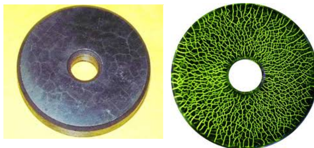
6.15. ábra. MTU tárcsa: balra természetes fényben, ezért a repedések nem láthatóak ([ Grimas web ]); jobbra UV fényben, ami miatt a repedések ragyogó zöld indikációja kitűnően megfigyelhető ([ ELECTRO-SPECT TESTING INC. web ])
