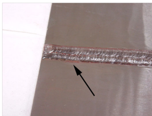
5.15. ábra. Hegesztési hiba szárazporos kimutatása [NDT web]
