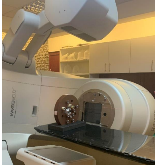
13. ábra: Varian TrueBeam 2.7 lineáris gyorsító CBCT karokkal, kezelő asztalon Gammex RMI 467 képminőség fantom.
