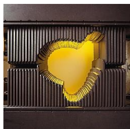
1. ábra: Soklemezes kollimátor (MLC). [1]
