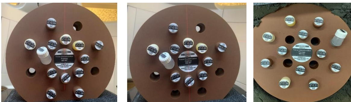
16. ábra: a. Gammex RMI 467 nagy sűrűségű inzertek nélkül; b. csont inzertek nélkül; c csont inzertek nélkül áthelyezett pozíciókban.
