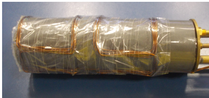
4.42. ábra. Az első elkészített Golay-tekerics, N=6 menetszámmal.
