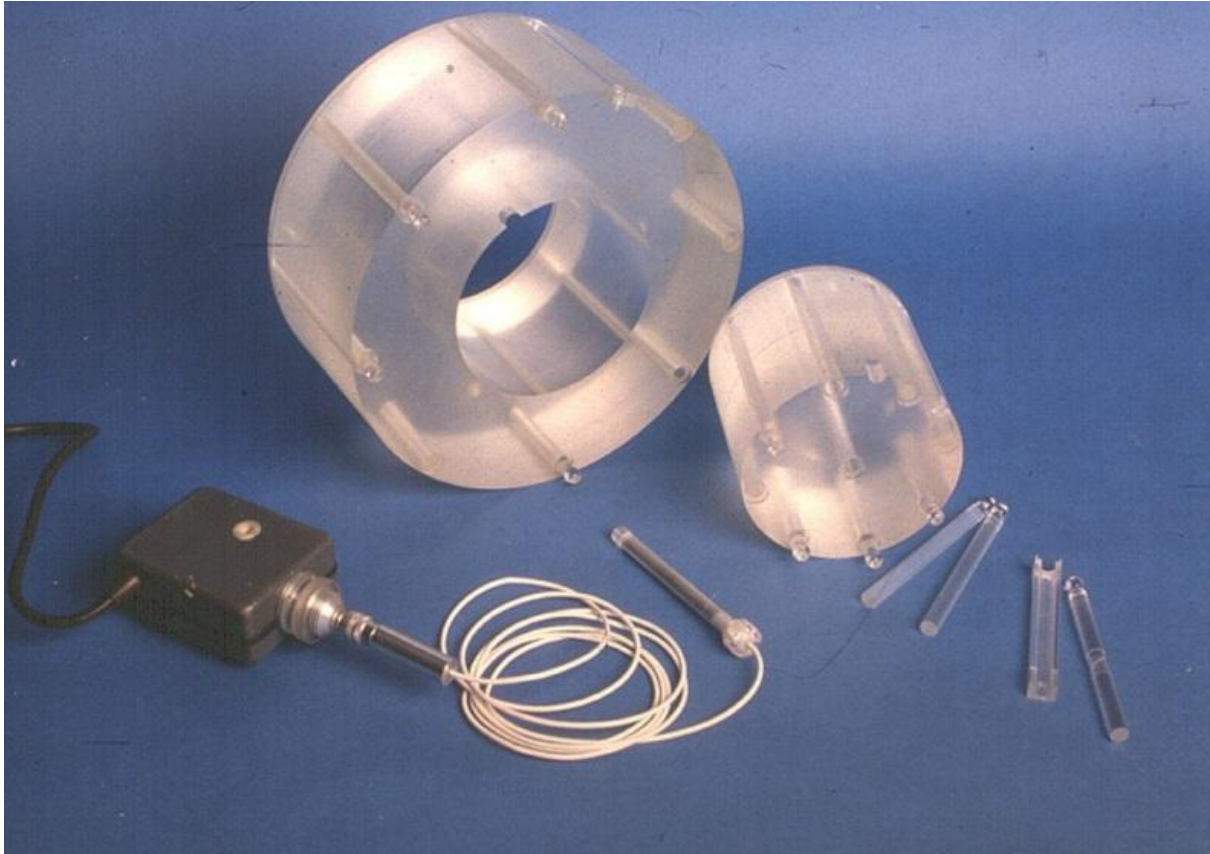
1. ábra: Szabványos test, illetve fejfantom CT dozimetriához, betétekkel (illusztráció)
