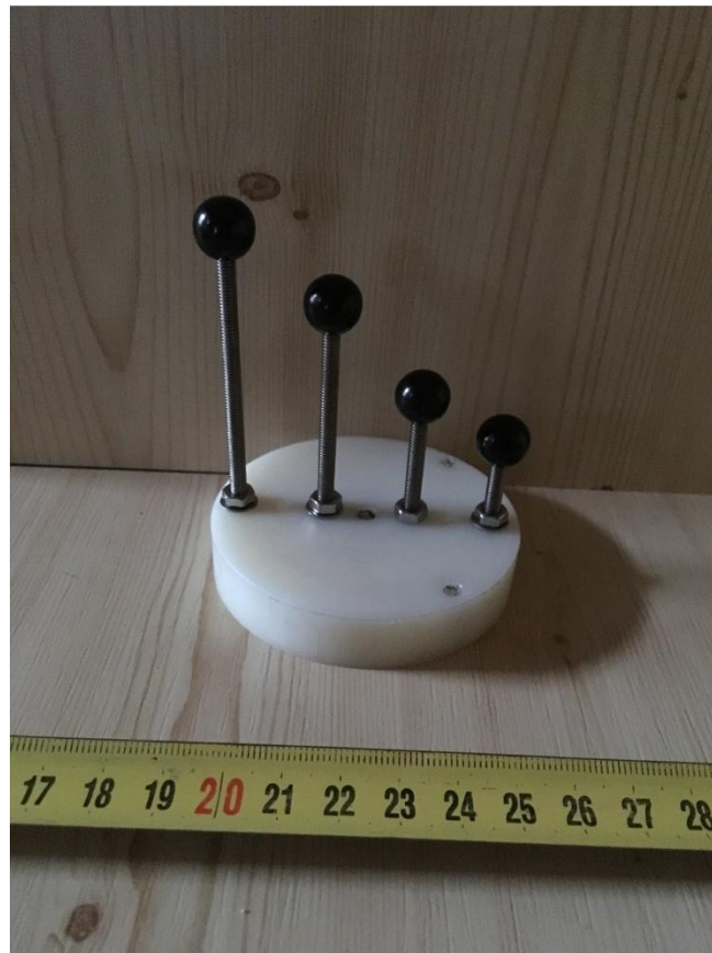
9. ábra - Az elkészült fantom. A függőlegesen álló menetes szálak egymástól 2 cm-re helyezkednek el.
