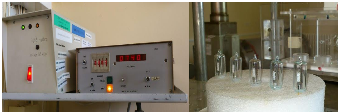
21. ábra: A Pille dózismérők kalibrálása. A baloldali kép a kalibráló sugárforrás időzítője, a jobboldalon láthatók a Pille készülék bura dózismérői
