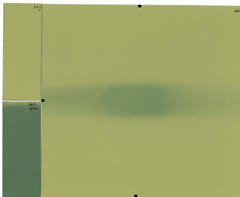
20. ábra - A "Onescan" protokollnak megfelelő film elrendezés, jobb felső sarkukban jelölve, egy üres kis film és egy a terv maximális dóziséjánál minimum 20%-ánál nagyobb dózissal besugározott kis film, egyszerre beszkenelve. A filmen látható négy pont, az izocentrumot jelöli, ez a film fantomra ragasztása után a lézerek metszésénél kell berajzolni.
