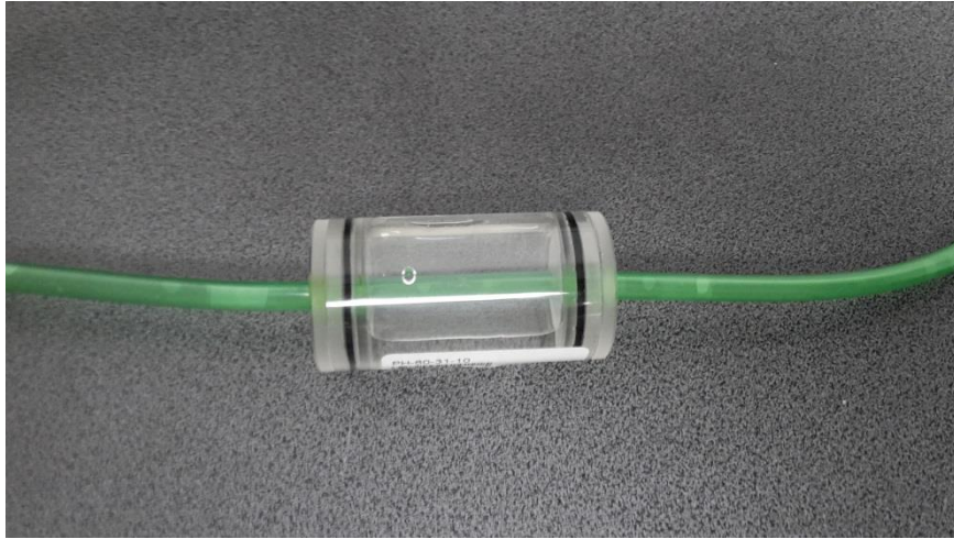
33. ábra: Nyugvó szövetek közt áramló vért szimuláló fantom
