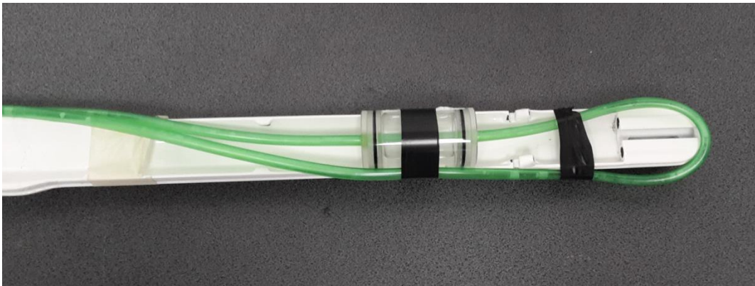
34. ábra: a TOF teszteléséhez készített fantom mérés előtt, már a fektetőágyhoz rögzítve. A fektetőágy segítségével lehet a fantomokat/ állatokat a berendezésbe helyezni.
