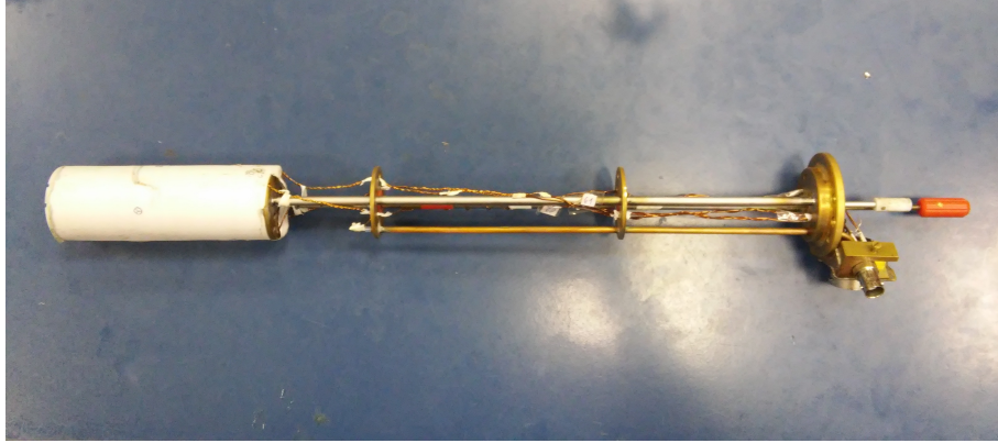
15. ábra. A használt mérőfej. Baloldali vége a mintatartó, a gradiens és RF tekercsekkel, jobb végén az RF és gradiens kábelek csatlakozása.
