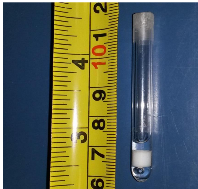
32. ábra: Egydimenziós vizsgálatokhoz használt, két részre osztott víz fantom
