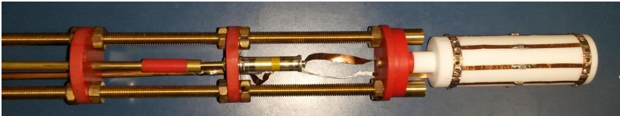
8. ábra: Mérőfej a proton birdcage tekerccsel [2]
