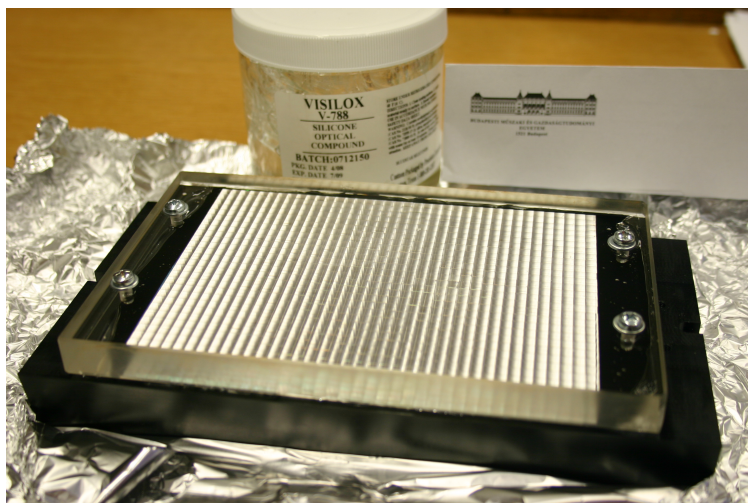
27. ábra. A Mediso humán PET pixelezett szcintillációs kristálmátrixa. Az összerakás technológiáját az Atomfizika Tanszék fejlesztette ki.
