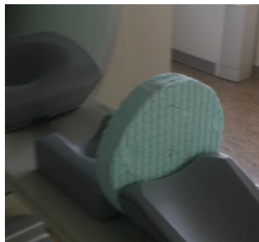
3.1. ábra: Az általam gyártott hungarocell-fantom
