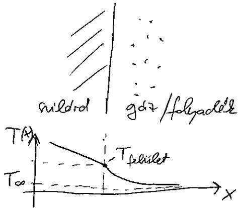
$T_{\text{felület}}$  a felület hőátverésre,  $T_{\infty}$  a gáz/folyadék hőátverésre végzetes mérté a felülettel
