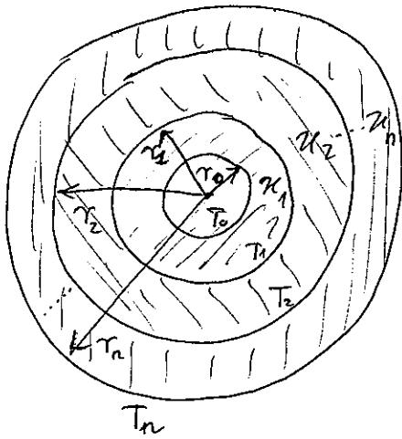
Adott a belső felület  $T_0$  hőmérséklete, a külső felület  $T_n$  hőmérséklete, valamint az  $n$  réteg  $\kappa_1, \kappa_2, \dots, \kappa_n$  hővezetési együtthatása.
