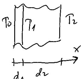
Most  $T_0 = 20^\circ C$  és  $T_2 = -10^\circ C$ ,  $d_1 = 3cm$  és  $d_2 = 30cm$ .
