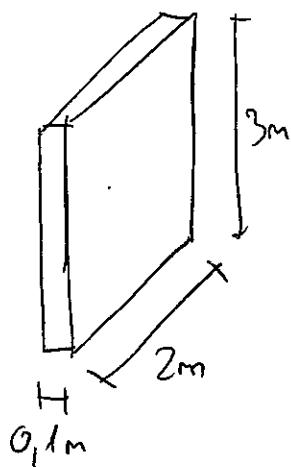
$$\dot{Q} = \int_{(A)} \dot{q} dA . \quad \text{Most } \dot{q} \text{ és } dA \text{ is mindenleges a felülete, azaz az irány: } \dot{q} dA = \dot{q} \cdot dA$$
