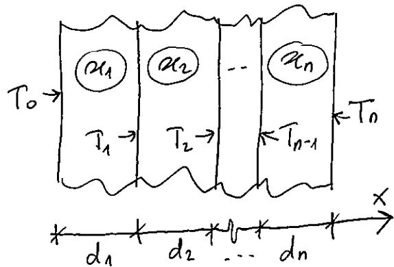
A rétegek soros elrendezésben, a hő áramban áthalad minden rétegiz rétegen.
