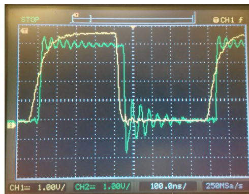
4. ábra. 1 MHz-es bemeneti négyyszögjel (sárga) és a kimeneti jel (zöld)
